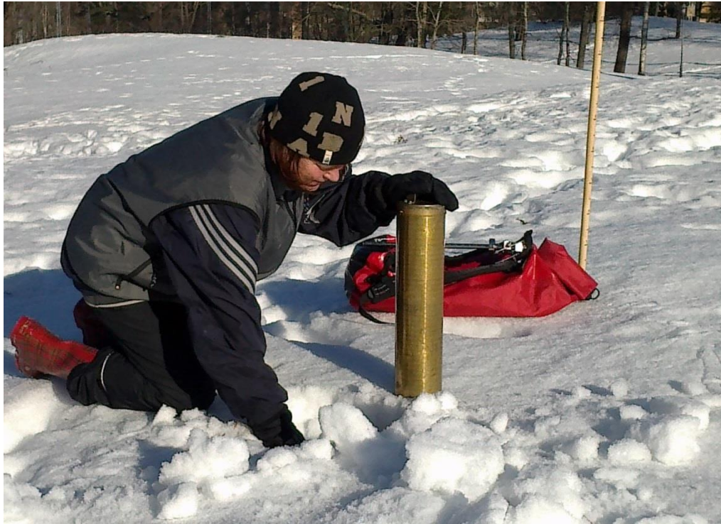
Kuva 4-9 Lumeen on kaivettu pystyseinäinen kuoppa, jonka reunasta lieriö painetaan lumipeitteen läpi lapiota vasten
