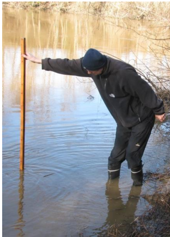
Kuva 2-19 Pohjapaalua lukemassa Vantaanjoella Myllymäessä
