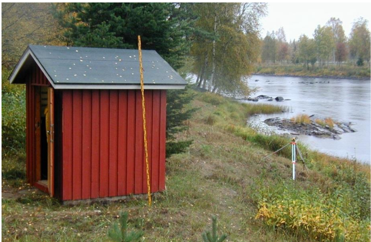
Kuva 2-16 Vaaituskoje ja puinen taittolatta Haukiputaalla
