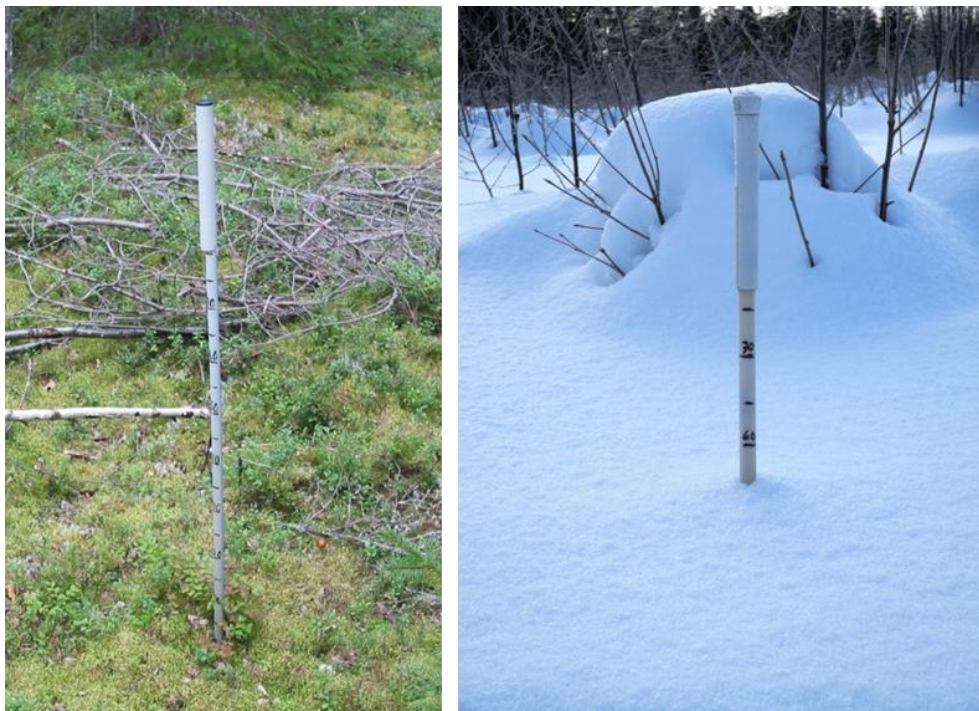
Kuva 8-1 Kaksi routaputkea hattuineen ja kyljessä olevine lumen syvyyden mitta-asteikoineen.
