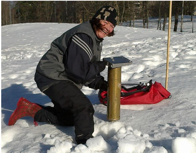
Kuva 4-10 Lieriö on nostettu ylös lapion avulla ja käännetty ylösalaisin
