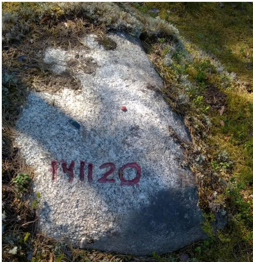
Kuva 2-10 Maanmittauslaitoksen 3. luokan korkeuskiintopiste
