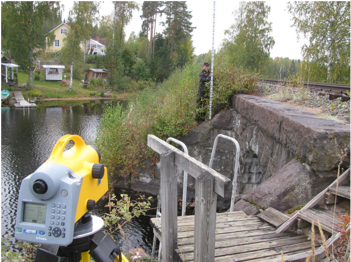
Kuva 2-12 Tarkkavaaitusta Ala-Kintauksen vedenkorkeusasemalla
