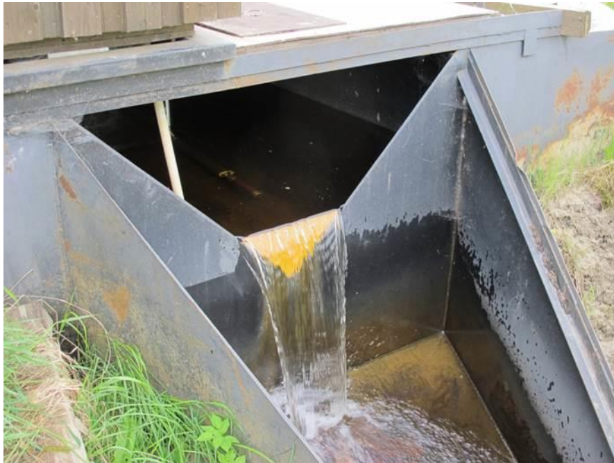
Kuva 9-2 Metallinen mittapato Teeressuonojan valuma-alueella
