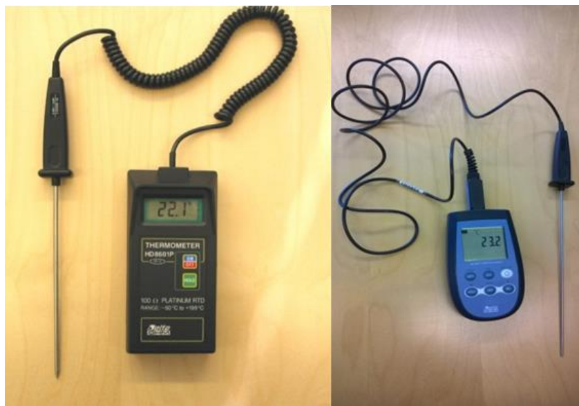
Kuva 5-3 Pintaveden lämpötilan käsimittareita tarkistusmittausta varten: vasemmalla vanhempi malli, oikealla uudempi malli.
