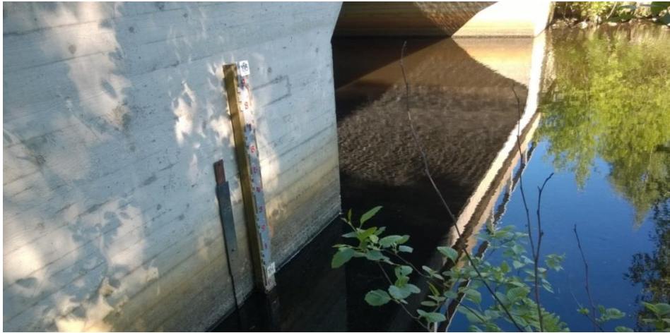
Kuva 2-5 Alajärven asteikko kiinnitettynä siltaan
