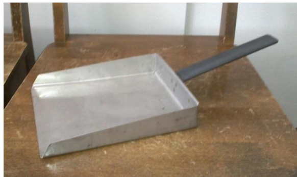
Kuva 4-6 Lumen punnituksissa käytettävä tasapohjainen lapiota
