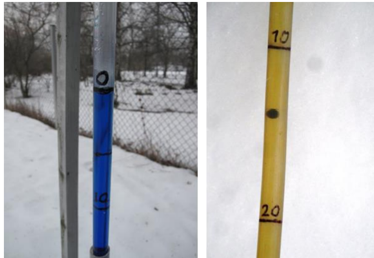
Kuva 8-4 Ensimmäisessä kuvassa roudattoman maan sisähavaintoputki. Toisessa putkessa mutteri osoittamassa noin 14 cm:n routaa (putkessa ei metyleenisiniä).
