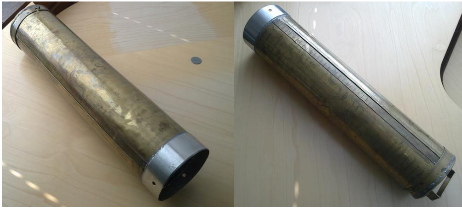
Kuva 4-5 Lumipuntarin lieriö. Lieriön kyljessä on mitta-asteikko lumen syvyyden lukemiseksi punnituksen yhteydessä.
