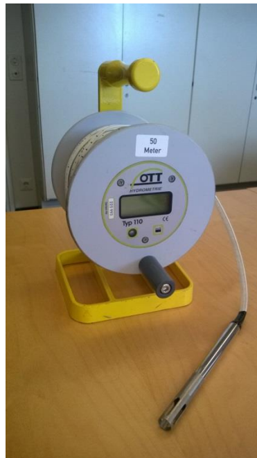
Kuva 5-4 Lämpötilaluotain (OTT) 50 metrin kaapelilla
