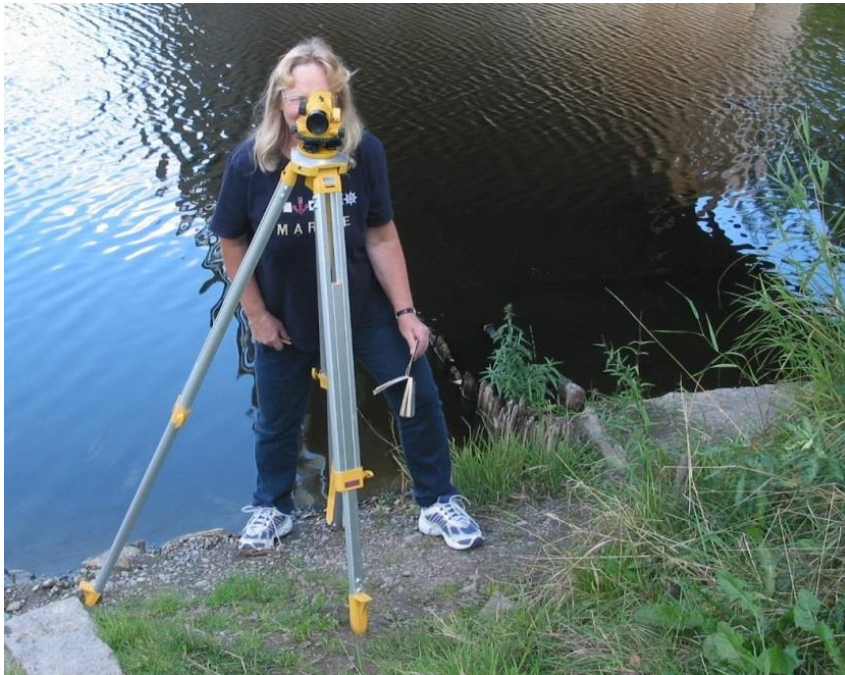
Kuva 2-15 Vaaitusta yleisvaaituskojeella Vekkoskella
