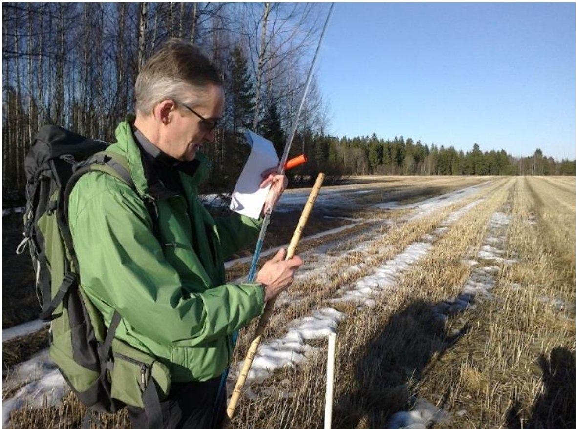
Kuva 8-3 Roudan syvyys luetaan läpinäkyvän jäätyneen ja sinisen sulan nesteen rajakohdasta.
