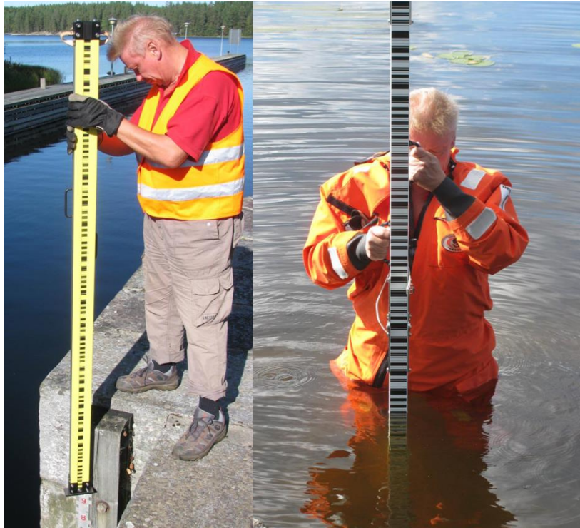
Kuva 2-14 Vasemmalla viivakoodi-invar-kiintolatan käyttöä Kermajärvellä, oikealla taittuva viivakoodi-puulatta Synsiön pohjapaalulla
