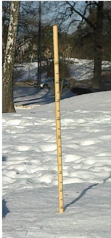
Kuva 4-3 Mittasauva lumen syvyyden mittaamiseen
