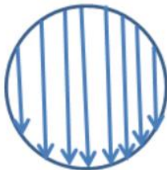
Kuva 6. Kyvetin pohja käydään läpi etenemällä pystysuoria "raitoja" pitkin.
