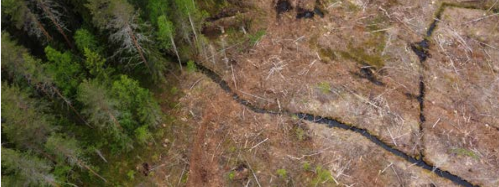
Kuva 52. Ojaksi perattuja ja edelleen tilaltaan heikentyneitä uomia saatetaan käsitellä metsätaloustoimien yhteydessä ojien tapaan. Kuvan ojaksi peratulle lähdepurolle ei ole säästetty avohakkuiden yhteydessä suojavajöhykettä. Uomaan on myös kaivettu johtamaan alueen muita ojia. Kuvan vasemman laidan metsän suojaan säästetty lähdepuro-osuus kuvassa 55.
