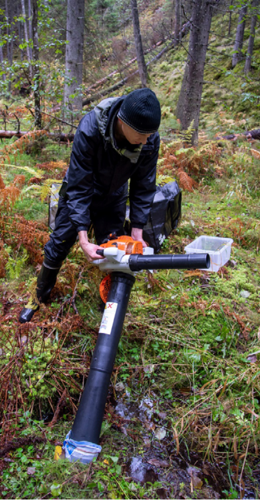
Kuva 5. Lehti-karkeimurista muokattu hyönteisimuri käytössä lähteiköllä. Kuva: Jari Ilmonen
