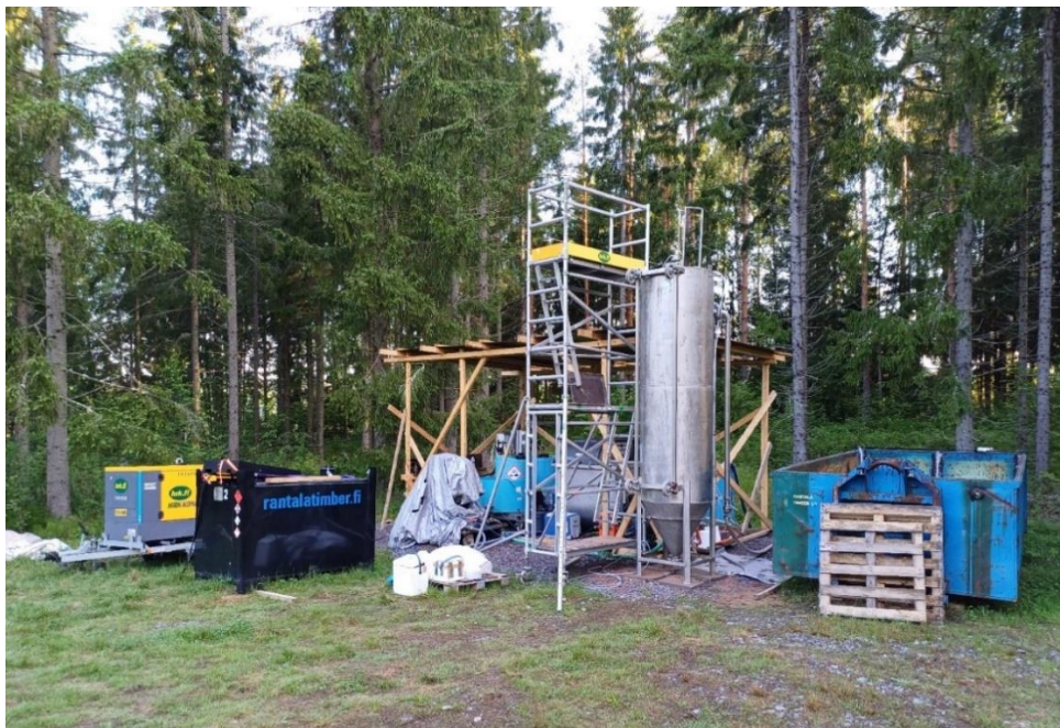
Kuva 9. Linkullasjön-järvellä kesän 2024 aikana pilotoitu alusveden suodatusjärjestelmä. Kuva: Laura Härkönen
