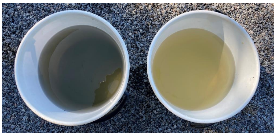
Kuva 3. Kymijärven hiekkasuodattimelle tuleva alusvesi (vasen) ja hiekkakentän läpi kosteikkoon suodattunut vesi (oikea). Kuva: Soila Silvonen.
