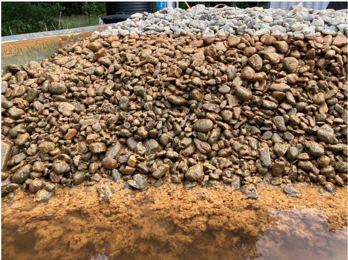
Kuva 7. Jos rautapitoisuus alusvedessä on korkea ja valuma-alueella käytettävissä oleva pinta-ala rajallinen, alusveden raudan esisuodatus esim. kuivasuodattimena toimivan kivipedin läpi on yksi vaihtoehto. Kuva: Leena Nurminen.
